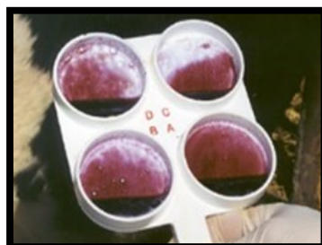
Rotar la paleta CMT en una movimiento circular por no mas que 10 segundos.
