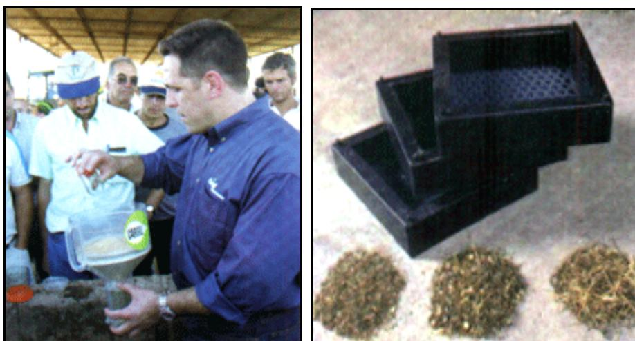
a)-Con el medidor de partícula de Cargill se puede medir el tamaño de molienda de los granos, de los silos de gramíneas y también de leguminosas; b)-Separador de partículas de Pennsylvania que permite visualizar cual es la relación existente en el tamaño de partícula con todos los forrajes de la dieta.
