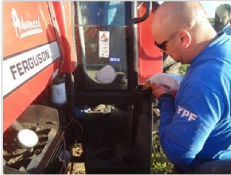
Figura 5: Medición de consumo de combustible
