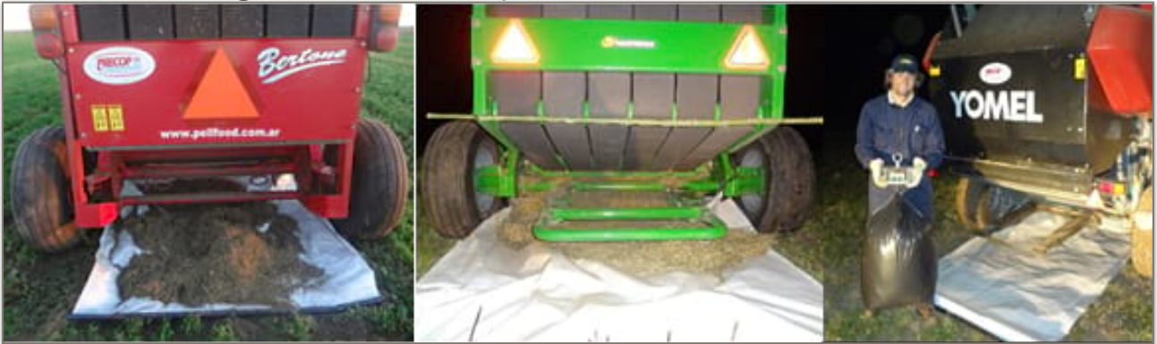
Figura 2: medición de pérdidas en rotoenfardadoras
