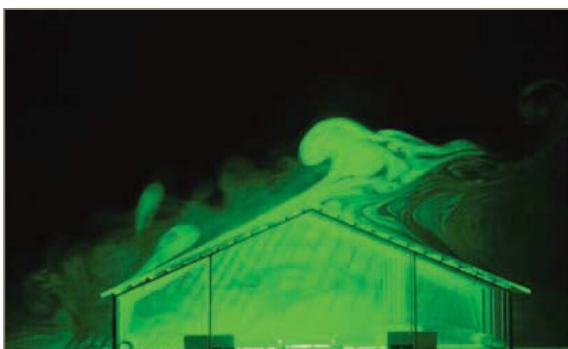
Figura 1. Sección de un establo en un túnel de viento iluminada con láser para observar las dinámicas de las corrientes de aire. Cortesía de ATB.
