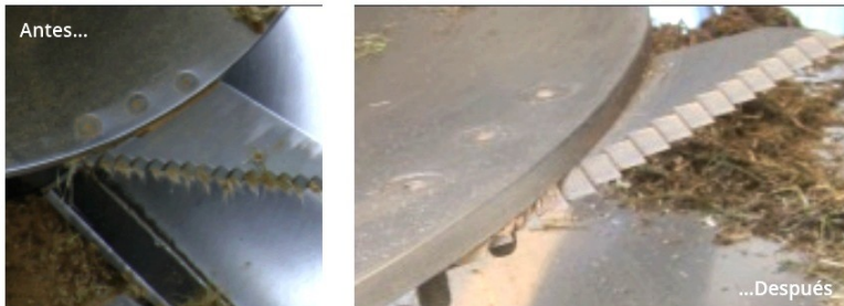
Figura 9. Recolocar las cuchillas para mejorar el picado.
