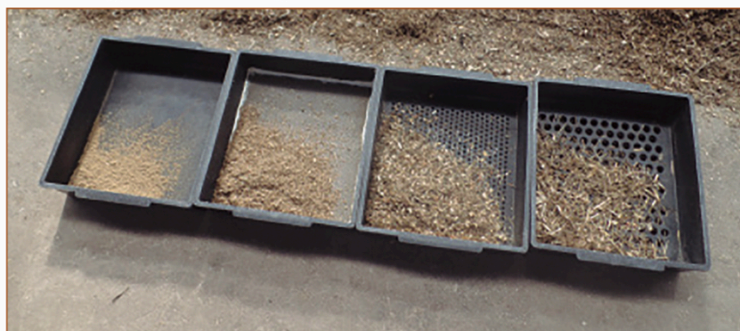
Figura 4. Tamices y bandeja del Penn State Separator
