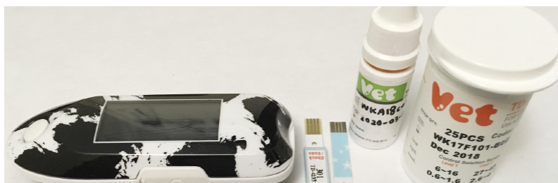
FOTO 1. Equipo Vet TD-4235 B-cetona DE TaiDoc para medir cuerpos cetónicos en vacas: monitor, chip para bovinos, tiras reactivas, solución de control para calibrar el monitor a cetonas en bovinos.
