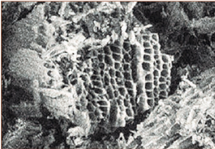
Figura 4. Estructura de los microporos del carbón activo (Sánchez et al. , 2012).
