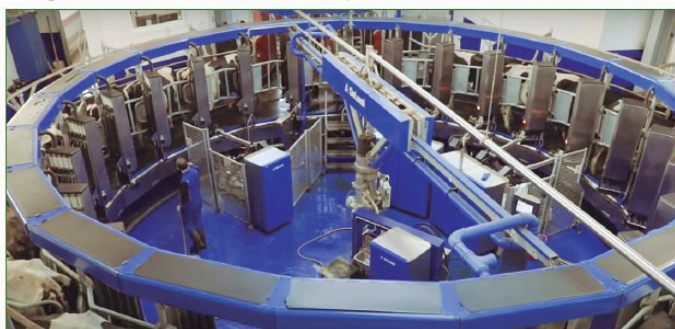
Figura 3. Brazos robotizados independientes en una sala rotativa
